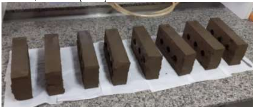
Figura 1. Posição dos tijolos para secagem natural em condição ambiente, sem circulação forçada de ar.
