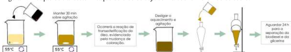
Figura 1. Reação de transesterificação de óleo de soja com álcool e hidróxido de sódio.
