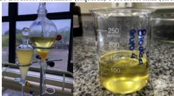
Figura 3. Decantação do Biodiesel sintetizado (esquerda) e biodiesel final (direita).
