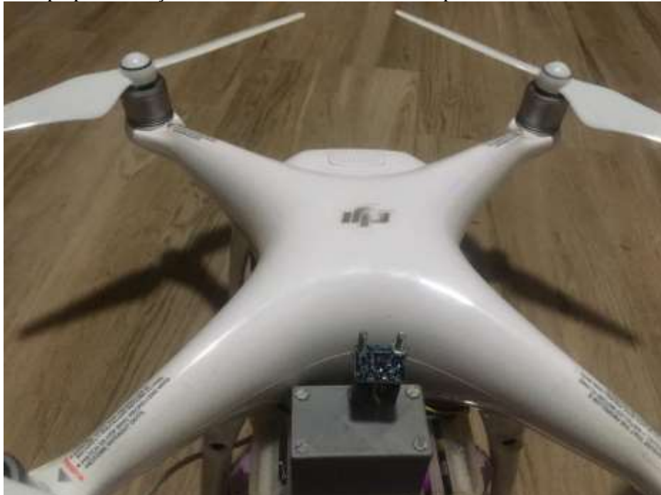
Figura 1. Protótipo para medição da luminosidade ambiente acoplado ao drone utilizado no estudo
