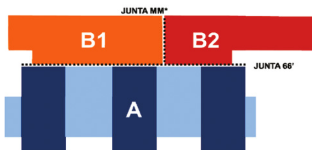
Blocos estruturais e juntas de dilatação
