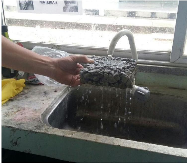
Figura 5 – Teste básico de infiltração das peças de concreto permeável.
