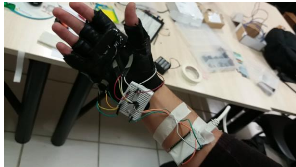
Figuras 2 e 3. Diagrama de blocos esquematizando a luva e fotografia do protótipo inicial da luva
