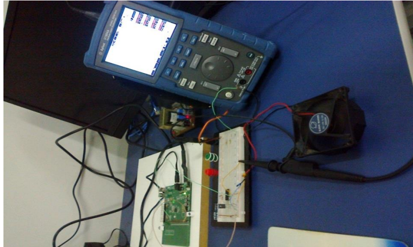
Figura 6 (a) – Geração do sinal PWM de Temperatura – 40% em nível alto e 60% nível baixo.
