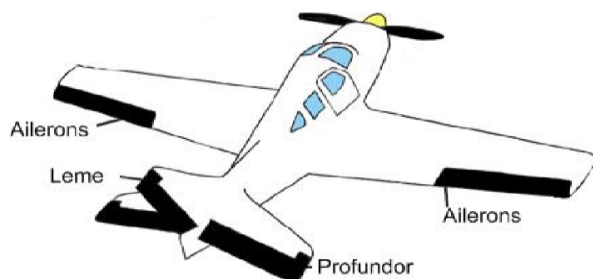
Figura 3 – Representação das superfícies de controle. Fonte: http://www.aeromodelismoonline.com.br
