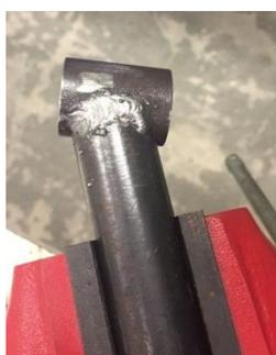
Figura 1. Perfil do cordão de solda aplicado no chassi.
