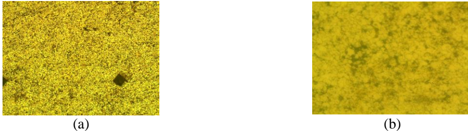
Figura 6. Microscopia óptica do aço SAE 1020 trefilado a frio. (a) ampliação de 100x revelando o refino do grão; (b) ampliação de 400x mostrando as fases ferrita (grãos claros) e perlita (grãos escuros).
