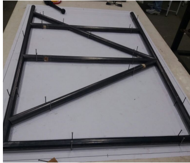
Figura 3. Fixação dos tubos do chassi com gabaritos de pregos.
