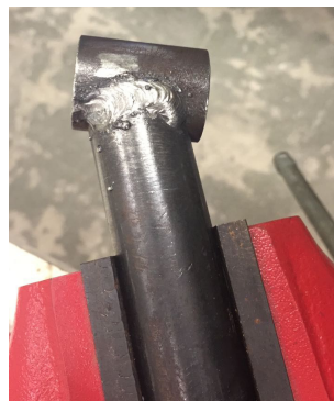
Figura 1. Perfil do cordão de solda aplicado no chassi.
