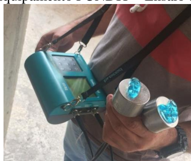
Figura 2 - Equipamento PUNDIT – Ensaio de Ultrassom
