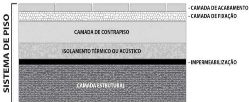
Figura 1. Sistema de Piso
