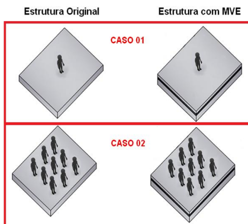
Figura 2. Aplicação do material viscoelástico em configuração sanduíche.
