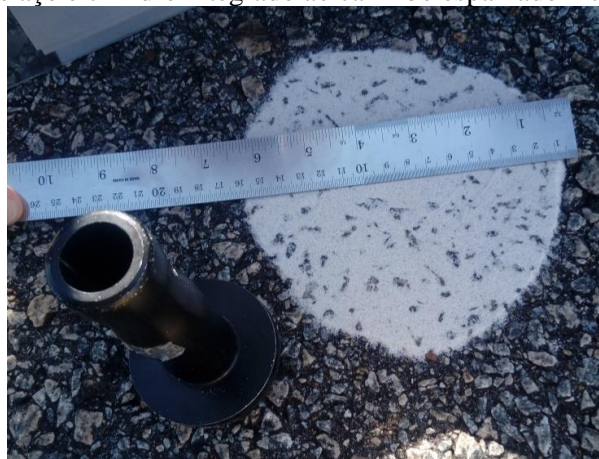
Figura 2. Régua de aço e cilindro integrado ao carimbo espalhador na pista em avaliação
