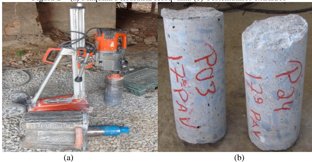
Figura 2 – (a) Máquina Perfuratriz Husqvama (b) Testemunhos extraídos
