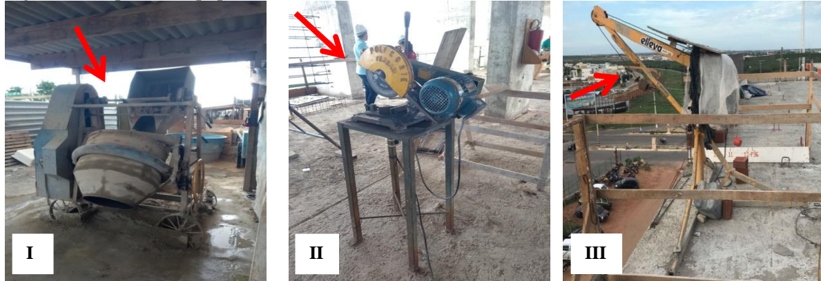
I: betoneira; II: policorte; III: visão lateral da mini grua. Fonte: Dados da pesquisa (2018).
