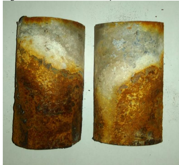
Figura 6 – Exterior da tubulação de 3/4”
