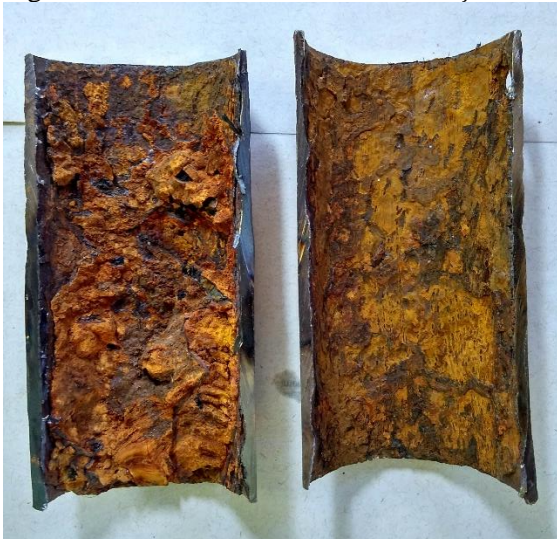
Figura 51 – Corrosão interna na tubulação de 3/4”
