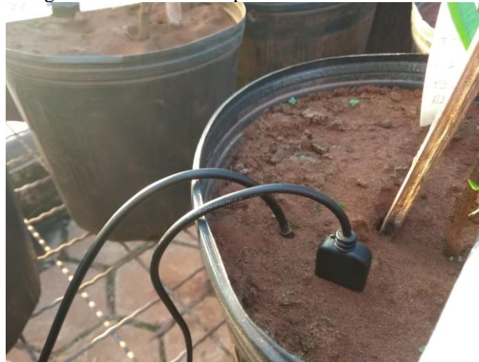
Figura 1 - Sensor de temperatura e umidade do solo.
