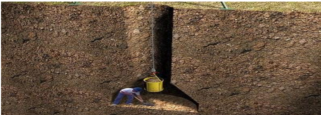
Figura 1 – Ilustração de Escavação a-céu-aberto
