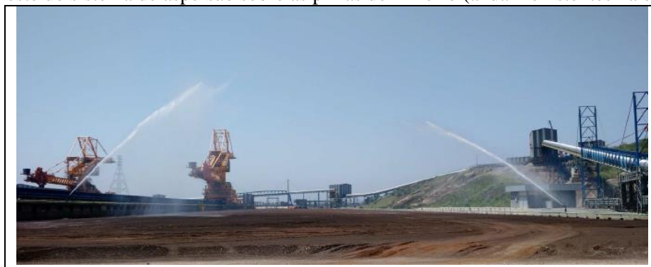
Figura 5 – Teste do sistema de aspersão sobre as pilhas de minério (anda inexistentes na época)
