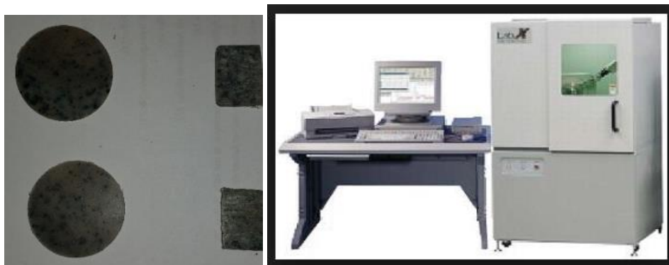
Figura 3- Ensaio de difratometria (a) amostras preparadas para o ensaio (b) Equipamento de ensaio.
