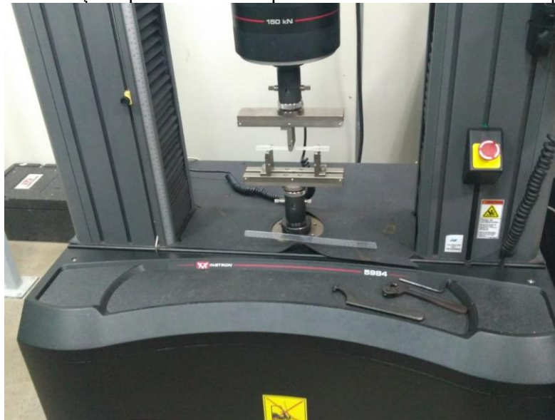
Figura 1. Esforço esquemático da máquina do ensaio de flexão em três pontos.
