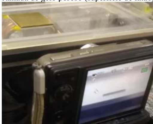
Figura 4. Processo de medição da espessura da camada de gelo poroso (superfície de latão).
