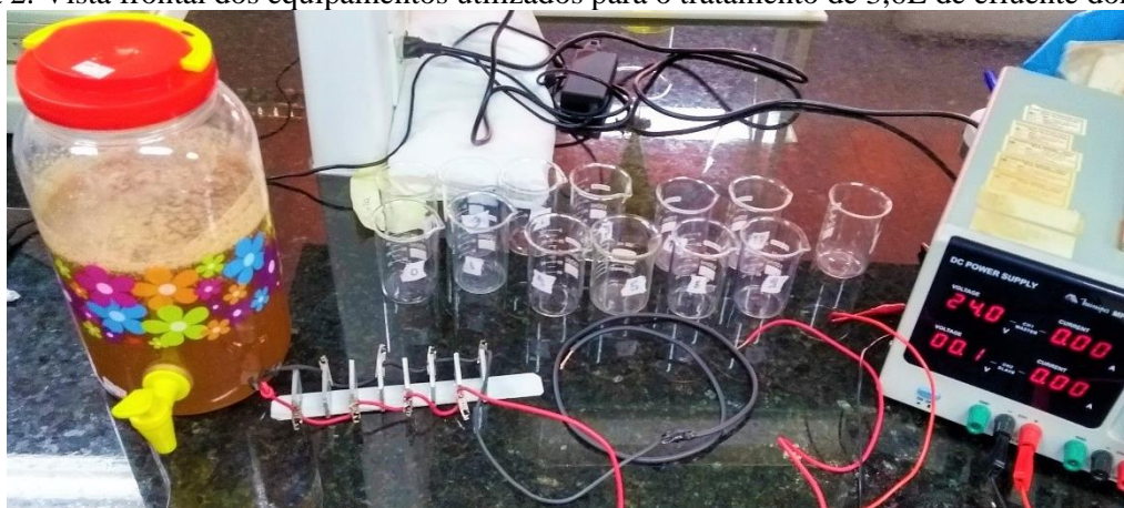
Figura 2. Vista frontal dos equipamentos utilizados para o tratamento de 3,6L de efluente doméstico.
