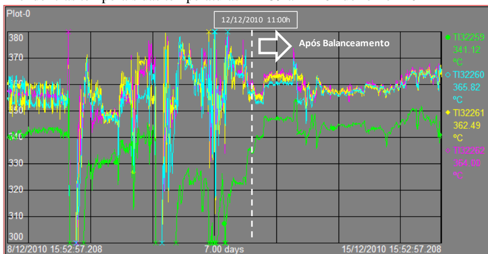
Figura 3 - Tendências temporais das temperaturas TI-259 a TI-262 do forno B-02A
